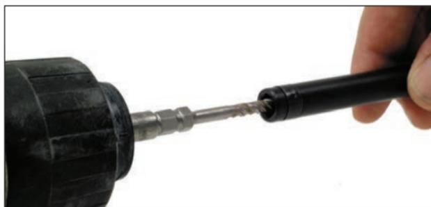
El adaptador hexagonal especial (incluido con el juego de instalación de tornillos Titen) permite que la herramienta de instalación Titen se deslice sobre la broca y se trabe, y quede así preparada para atornillar.
