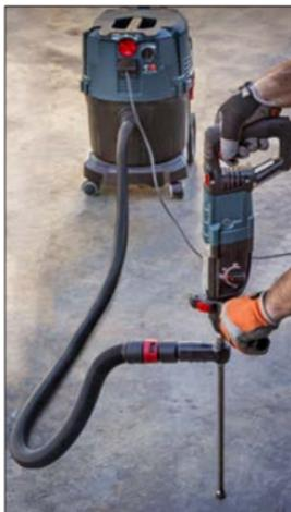
Broca DXS Bosch/Simpson Strong-Tie utilizada con sistema al vacío para la extracción de polvo
