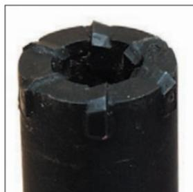
Detalle del cortador de varillas de refuerzo
