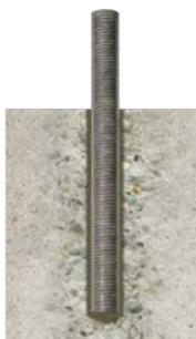
La nueva generación de adhesivos epóxicos Simpson Strong-Tie® es más confiable y versátil. El adhesivo para anclaje de alta resistencia SET-3G™, que figura en el informe de códigos ICC-ES ESR-4057, actúa en temperaturas de servicio extremas (de -40 °F a 176 °F), así como en entornos de concreto seco o saturado con agua, y ofrece esa gran capacidad de desempeño y resistencia a la adherencia que resultan imprescindibles para las aplicaciones de anclajes adhesivos de sus proyectos.
